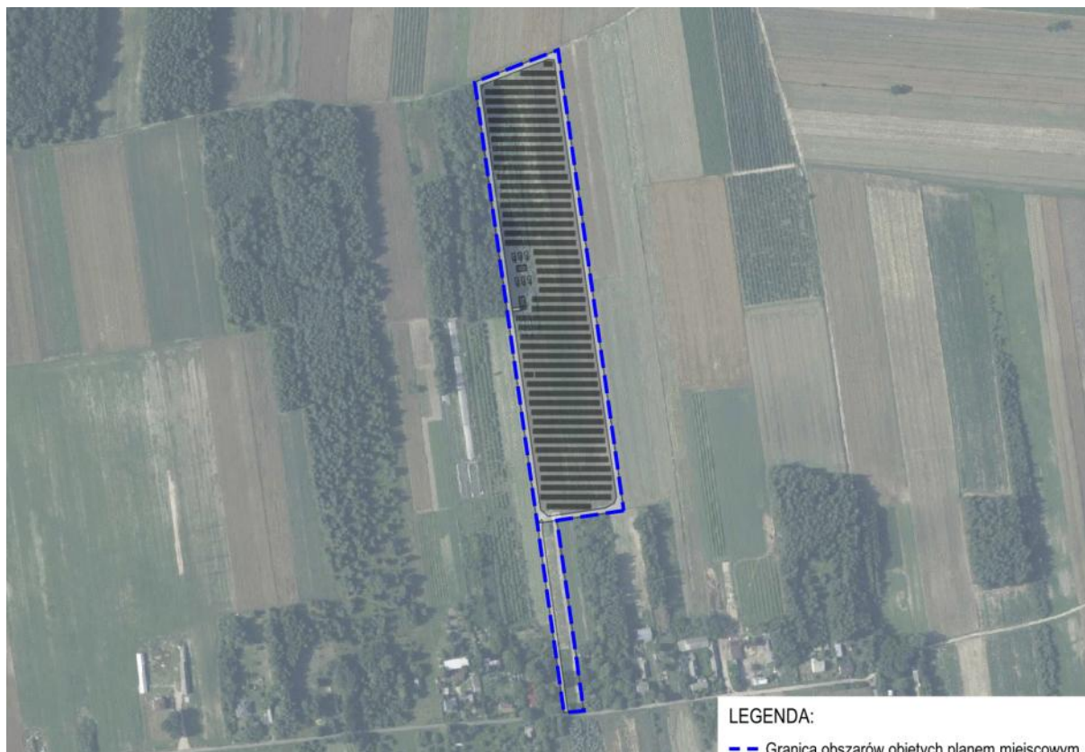
Rys.12. Wstępna koncepcja zagospodarowania terenu elektrowni słonecznej na terenie 2.1PEF.
